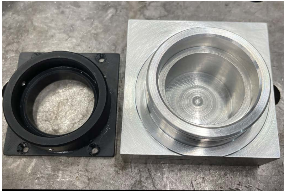
Abb. 5-12: Lampenhaushalterung in zwei Entwicklungsvarianten (links mit Klebeverbindung, rechts Rohling aus einem Stück gedreht).
