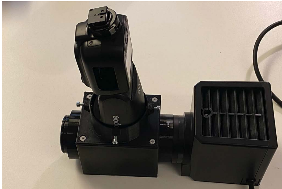
Abb. 5-3: Mikroblitzeinrichtung mit Blitzgerät und Lampenhaus in der gelieferten Erstausführung
