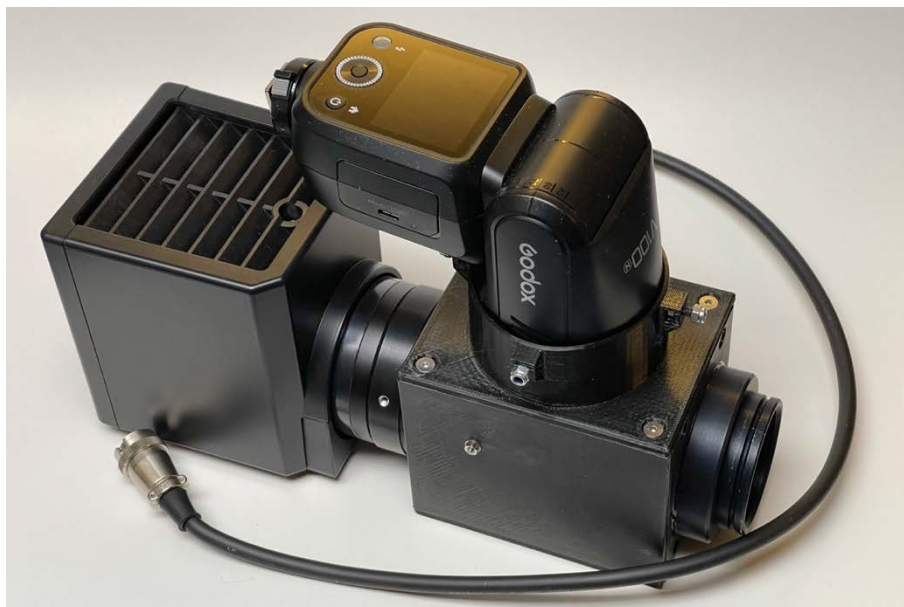
Abb. 5-8: Modifizierter Blitzwürfel mit Lampenhaus und Blitzgerät
