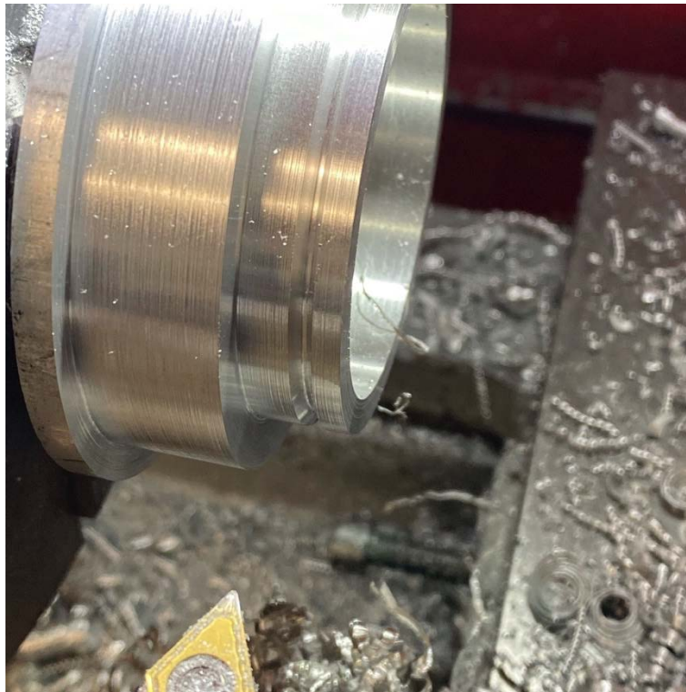
Abb. 5-5: Fertigung der Zentriernut auf der Drehmaschine
