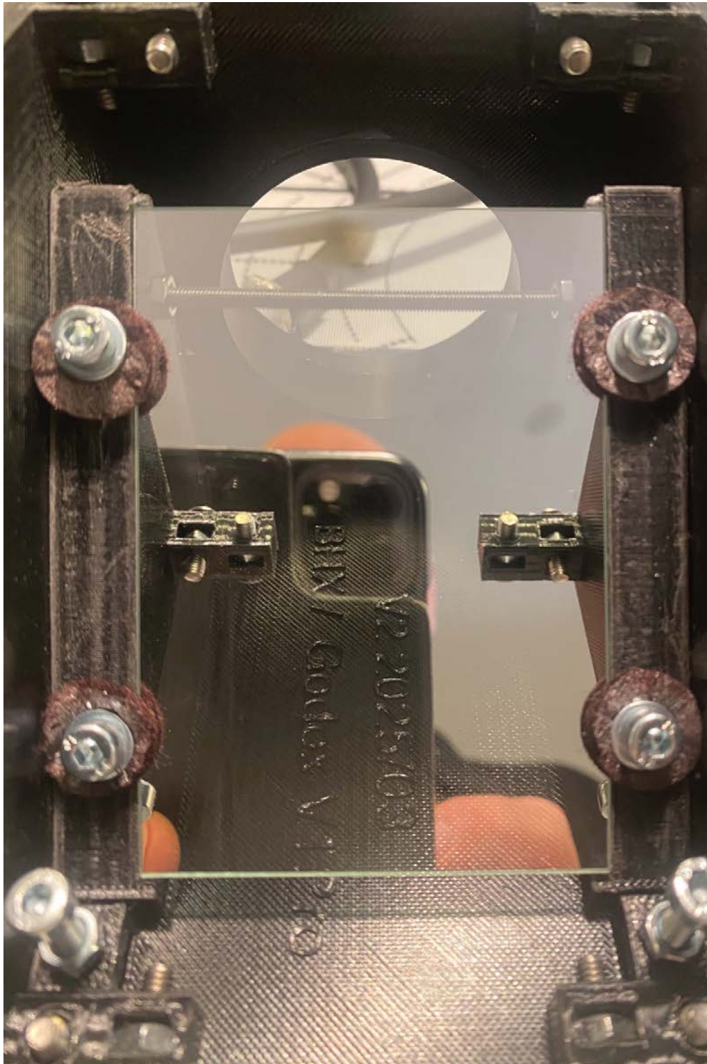
Abb. 5-2: Strahlenteiler mit modifizierter Befestigung und Domstrebe (Gewindestange mit Abstandsmuttern hinter dem teildurchlässigen Spiegel)
