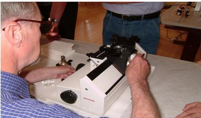
Abb. 23: Das Schlittenmikrotom der Firma Zeiss
